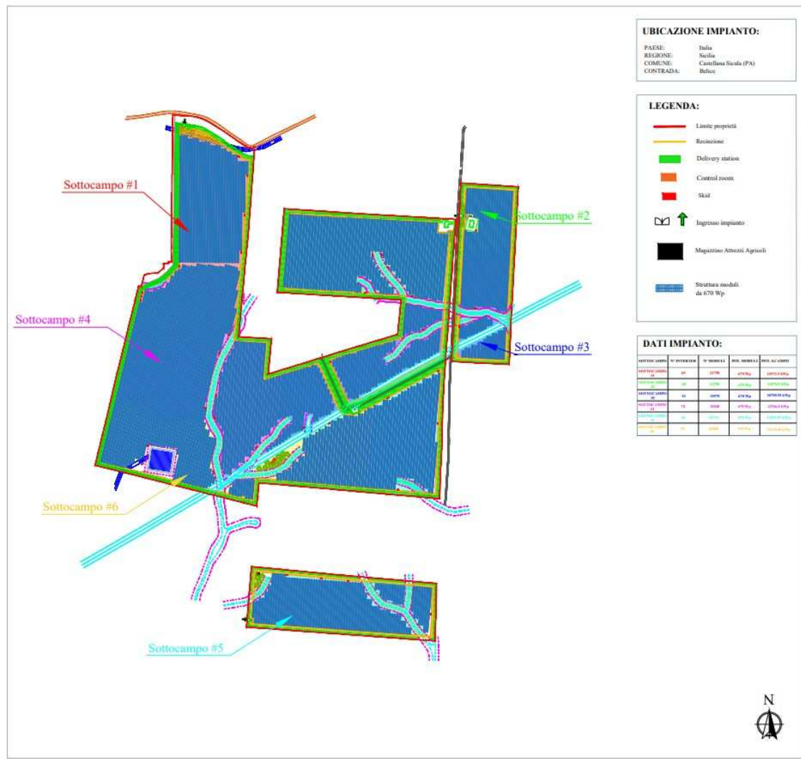
Figura 2 -Layout generale dell'impianto
