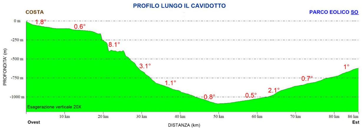
Figura 2.13 Profilo lungo il cavidotto del parco eolico Nord-Est (dati: EMODNet [25] e progetto MaGIC [28], [30], [32] e [34])
