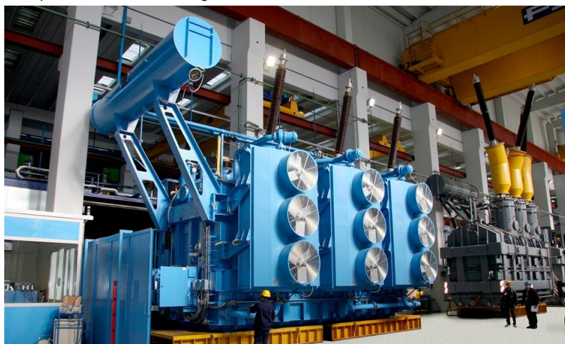
Figura 6.24 Esempio di trasformatore 220 kV/380 kV [Fonte: Getra Group]
