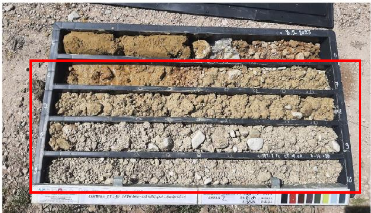
SONDAGGIO S-014 – Cassa n.2 da 5.00 m a 10.00 m
