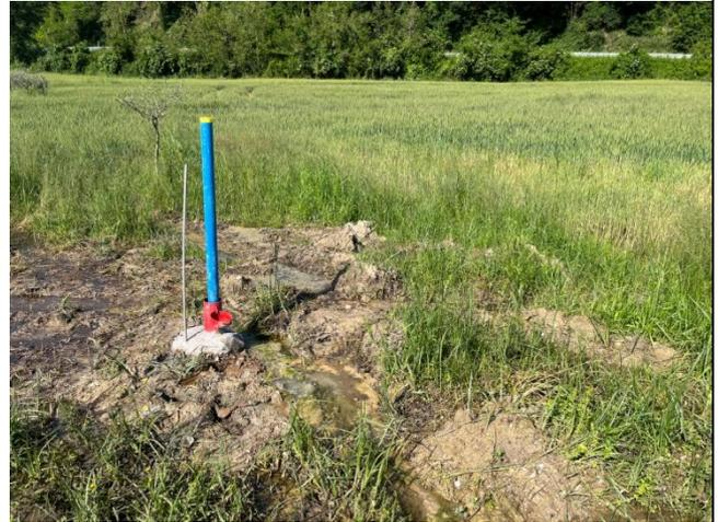
Pianura in corrispondenza del piezometro SO12 con falda sub-affiorante ed in pressione nei pressi del km 2+100.
