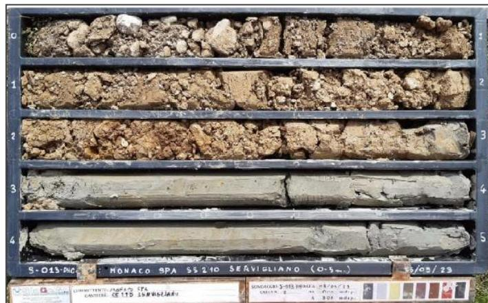
Figura 38- Sondaggio SO13: foto carote (0-5.m) con le ghiaie e le argille della formazione MUS<sub>bn</sub>.
