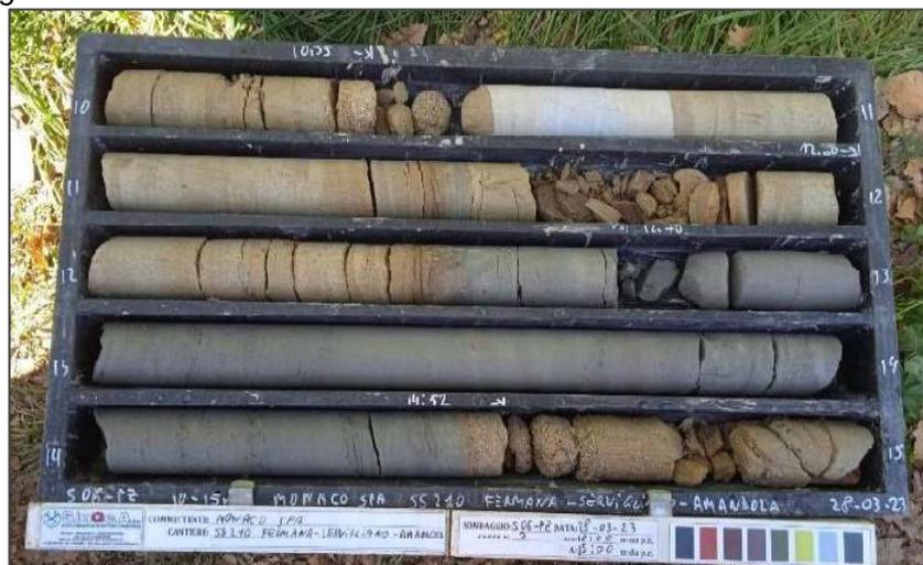
Figura 35- Sondaggio SO6 (spalla viadotto): foto carote (10-15.m) con le arenarie FAA<sub>3</sub>.
