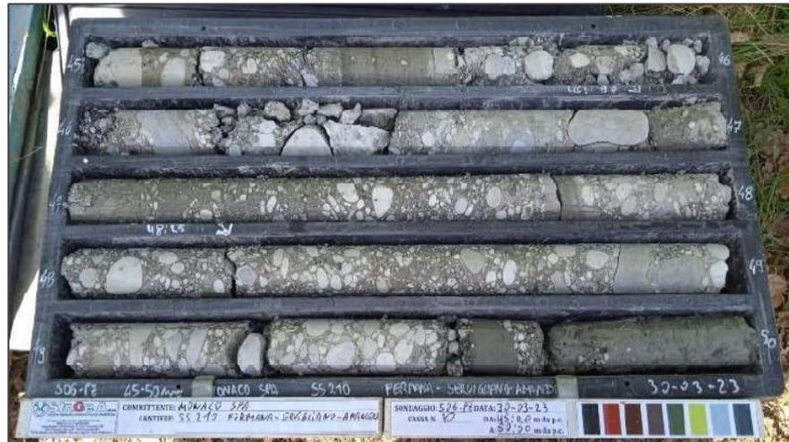
Figura 36- Sondaggio SO6 (spalla viadotto): foto carote (45-50.m) con il conglomerato FAA<sub>3</sub>.
