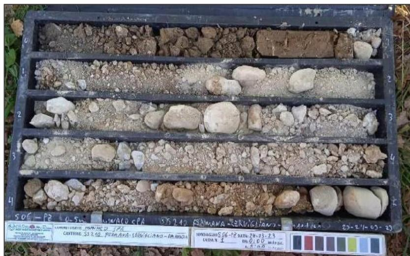
Figura 34- Sondaggio SO6 (spalla viadotto): foto carote (0-5.m) con le ghiaie sabbiose MTI<sub>bn</sub> al di sotto dello strato vegetale.
