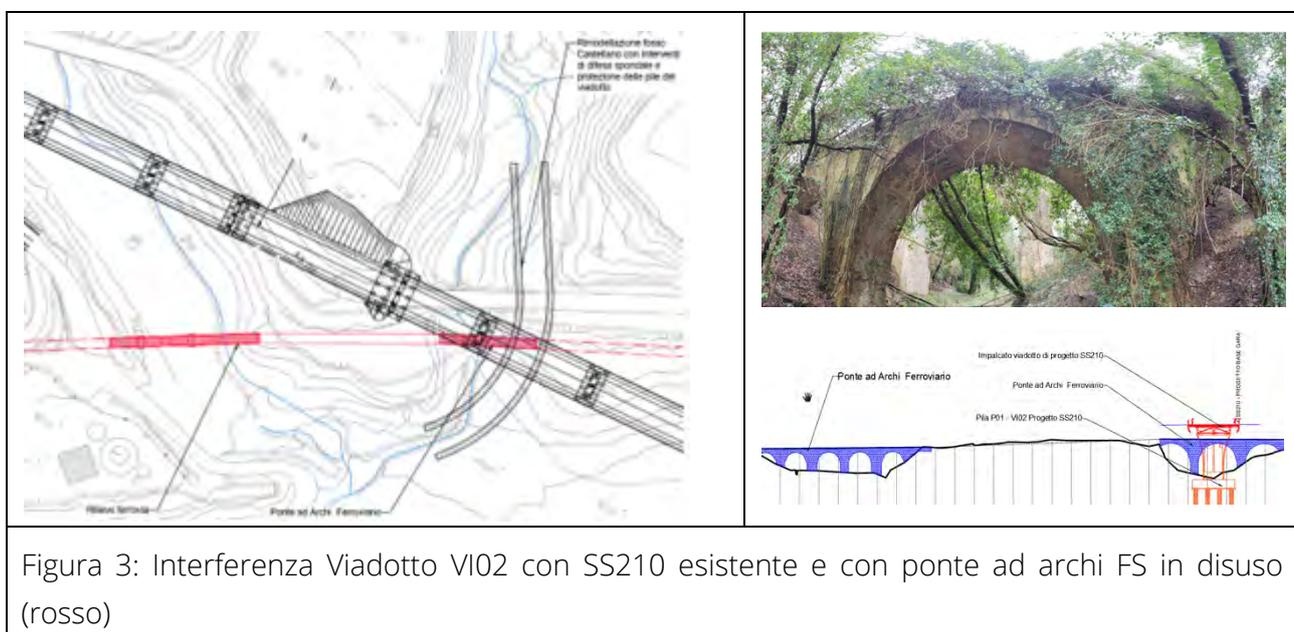
Figura 3: Interferenza Viadotto VI02 con SS210 esistente e con ponte ad archi FS in disuso (rosso)
