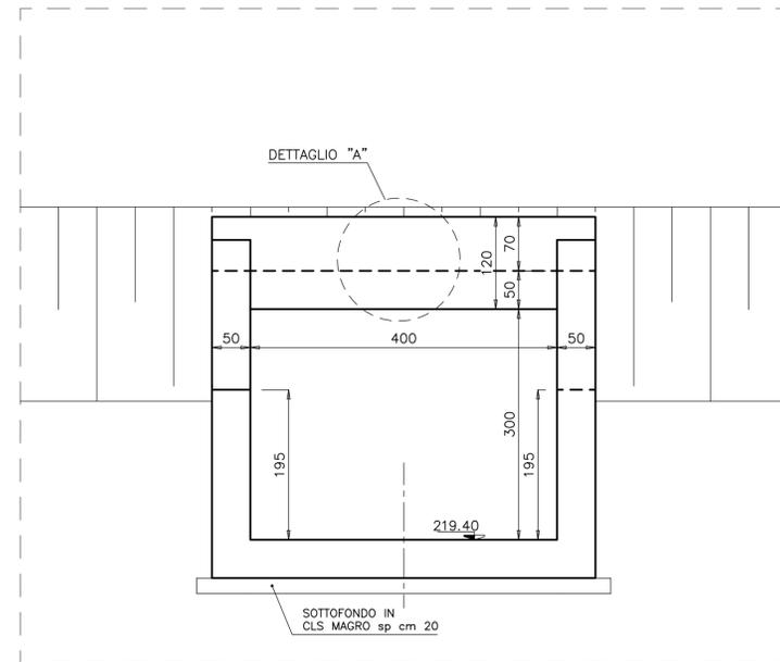
SEZIONE DETTAGLIO "A"
