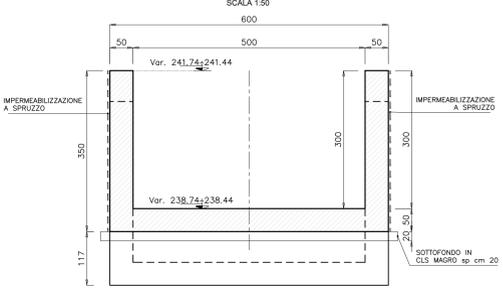
SEZIONE TRASVERSALE D-D scala 1:50
