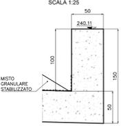
SEZIONE DETTAGLIO "B"
