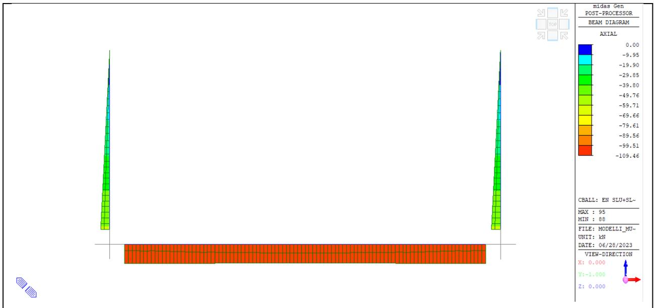
Figura 10: Azione assiale (kN) – Involuppo SLU+SLV
