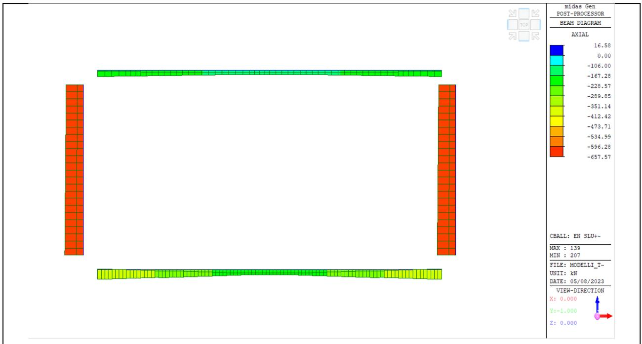
Figura 13: Azione assiale (kN) – Involuppo SLU+SLV
