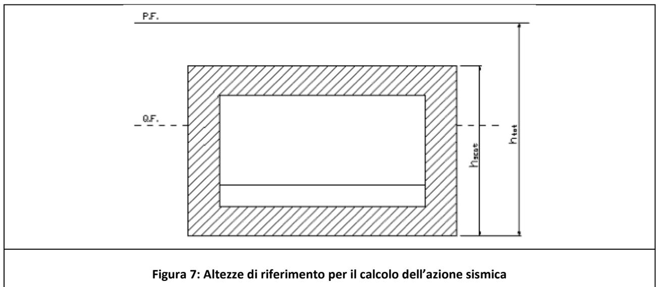
Tale distribuzione si sommerà alla spinta statica G delle terre secondo la combinazione allo stato limite ultimo, con coefficiente  $\gamma_1$ .
