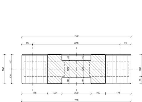
**PIANTA PULVINO PILE (VISTA SUPERIORE)**
