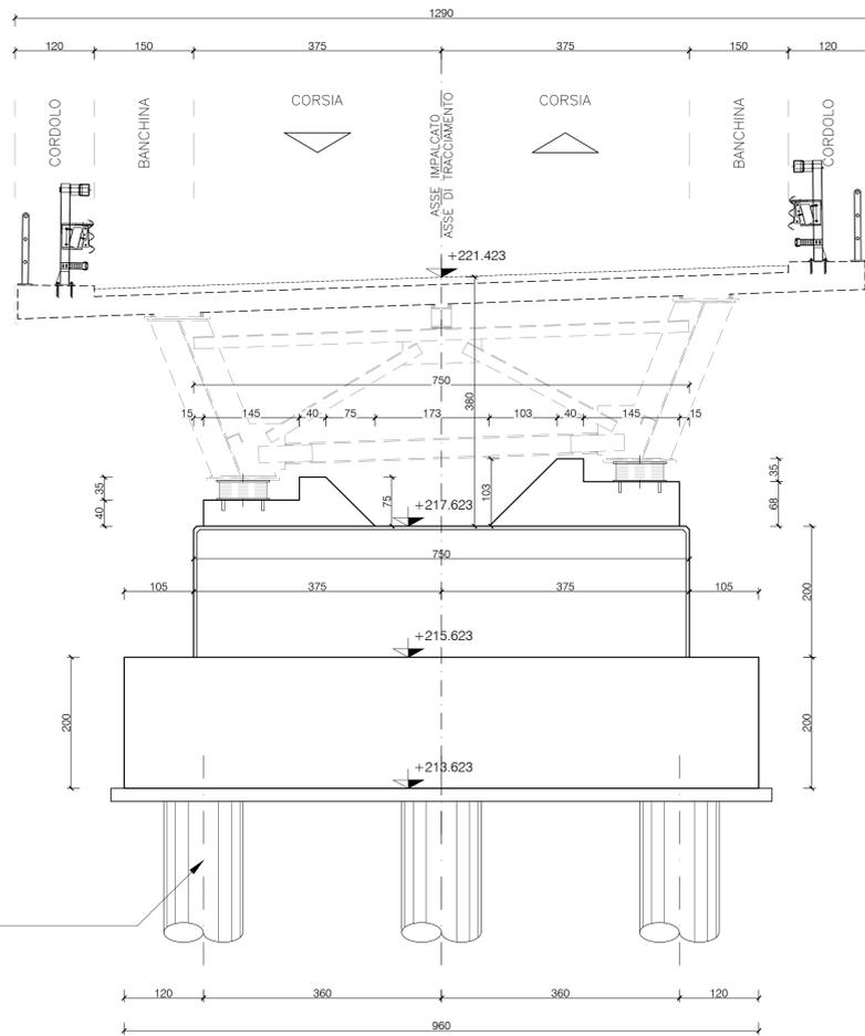
**SEZIONE LONGITUDINALE PILE**
