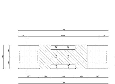
PIANTA PULVINO PILE (VISTA SUPERIORE)
