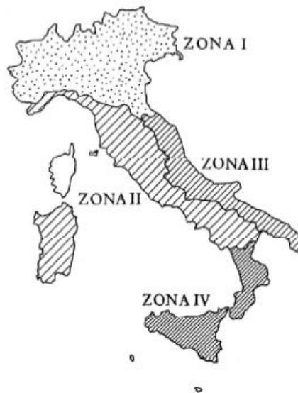
Figura 23 – Zone della temperatura dell'aria esterna (NTC2018)
