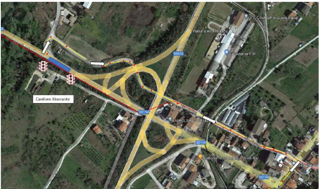
Figura 10 Viabilità interferenza cantiere SS154 - Piane d'Archi
