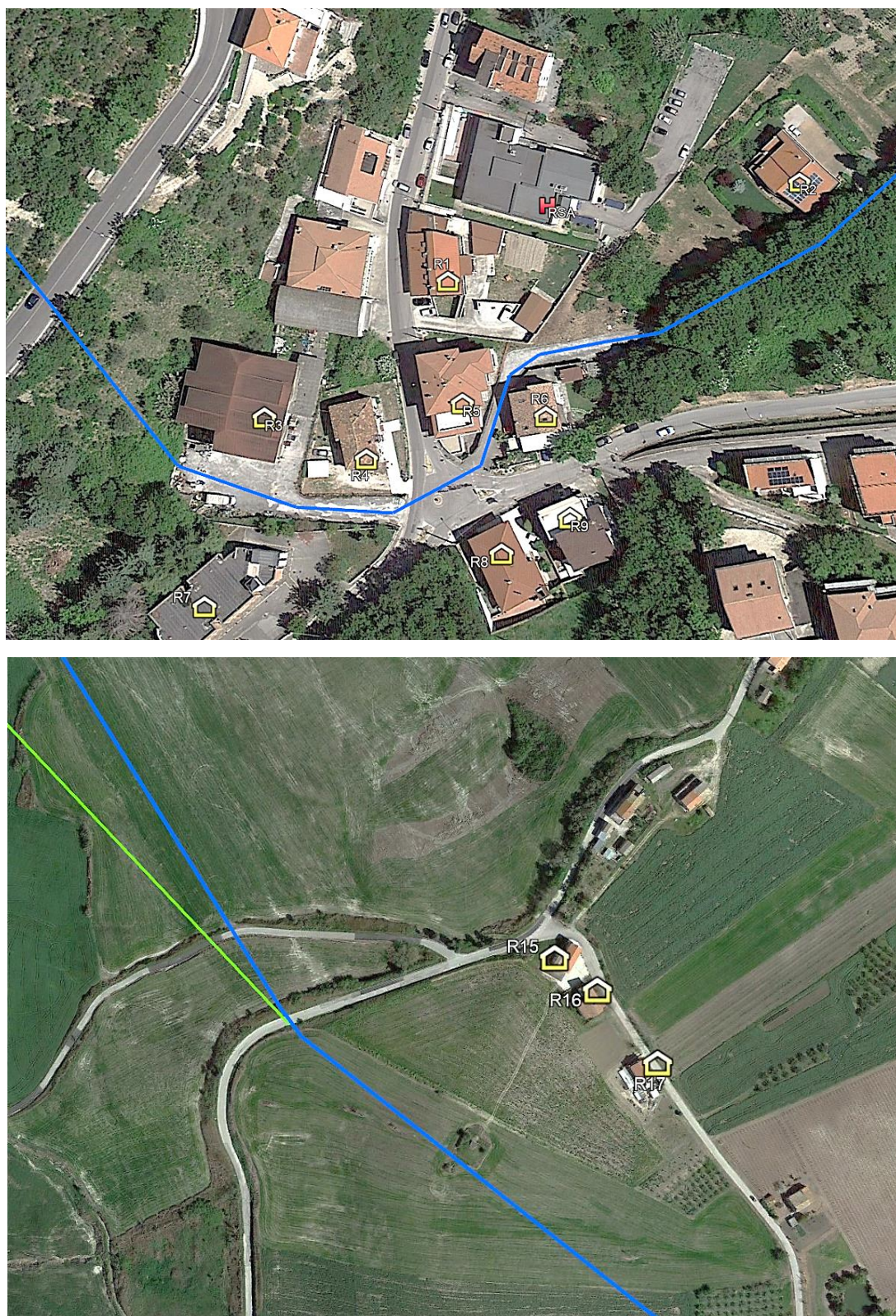
Figura 29 – Ortofoto 3D da Google Earth delle tre aree di cantiere e zone limitrofe analizzate con Ricettori più prossimi – in blu il percorso della condotta – in verde la linea di realizzazione pali di sostegno per frana
