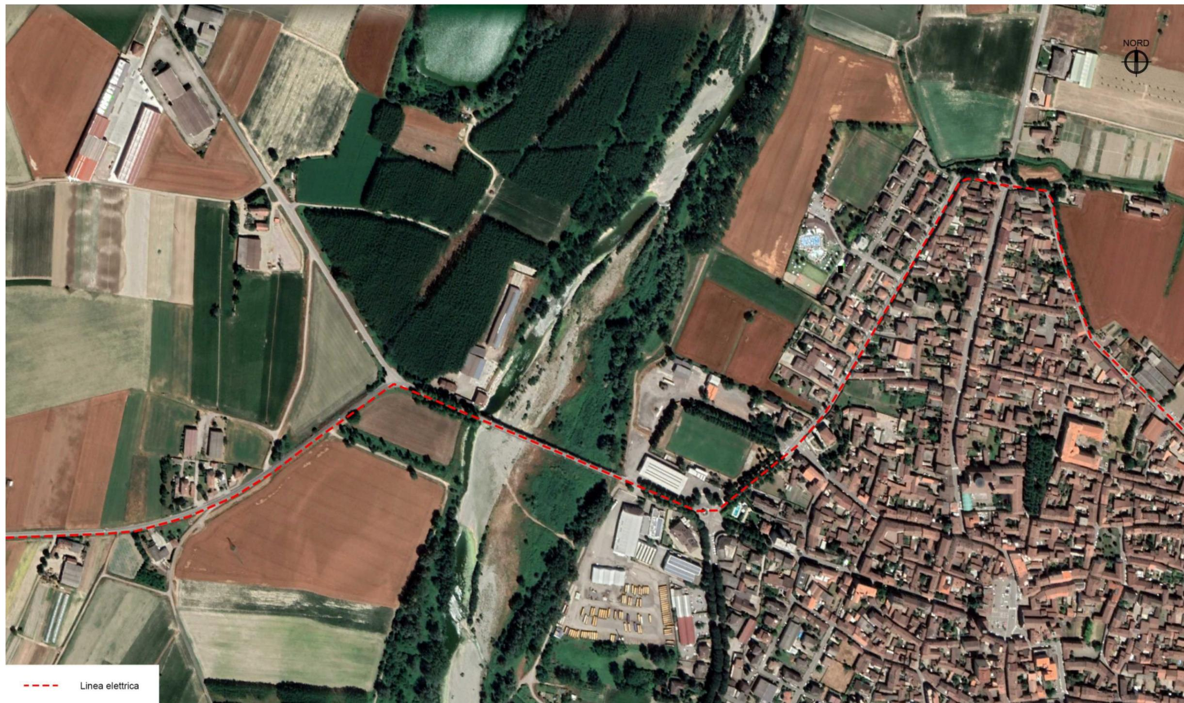
Figura 2 - Localizzazione su ortofoto della linea elettrica di progetto nel suo tratto di attraversamento del torrente Scrivia. Scala 1:5.000.
