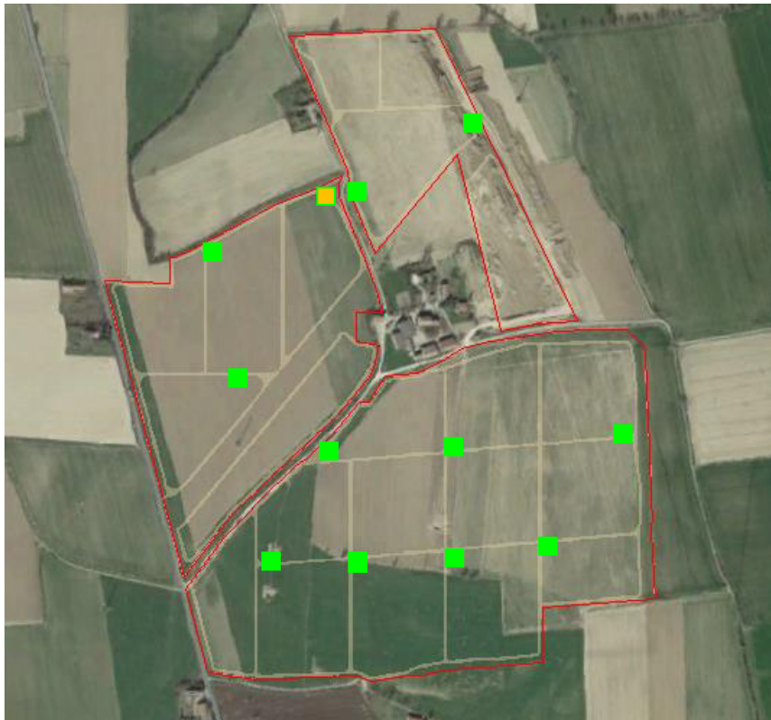
Figura 1: foto aerea dell'area di intervento – individuazione cabine e skid di trasformazione (in verde) e cabina di raccolta (in arancione)
