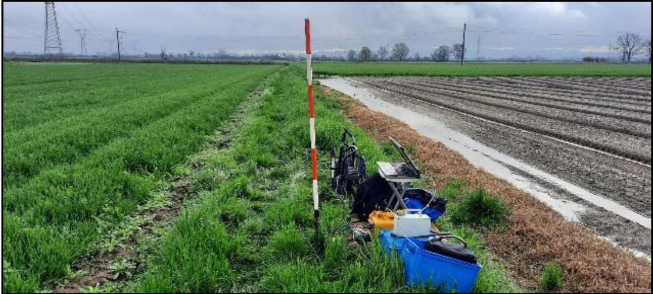
*Figura 28: Postazione di registrazione dati sismici: REMI 1*
