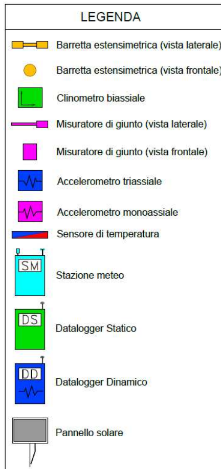
Figura 7-13 – Legenda strumentazione cavalcavia
