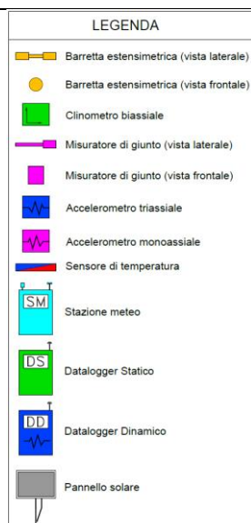
Figura 7-8 - Legenda strumentazioni ponti e viadotti
