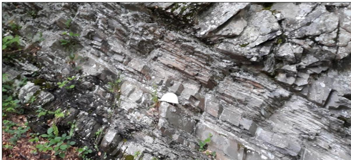
**Figura 2.6** Particolare di un affioramento della Formazione del Macigno nell'area a monte dello sbarramento lungo la strada che da Lago Ballano conduce a Lago Verde. Si tratta di torbiditi arenacei ed arenaceo – pelitici grigi con granulometria da media a medio – fine negli strati meno spessi e da grossolana a molto grossolana negli strati spessi, a cui sono subordinati livelli pelitici, costituiti da siltiti grigie, marne siltose ed argilliti grigie
