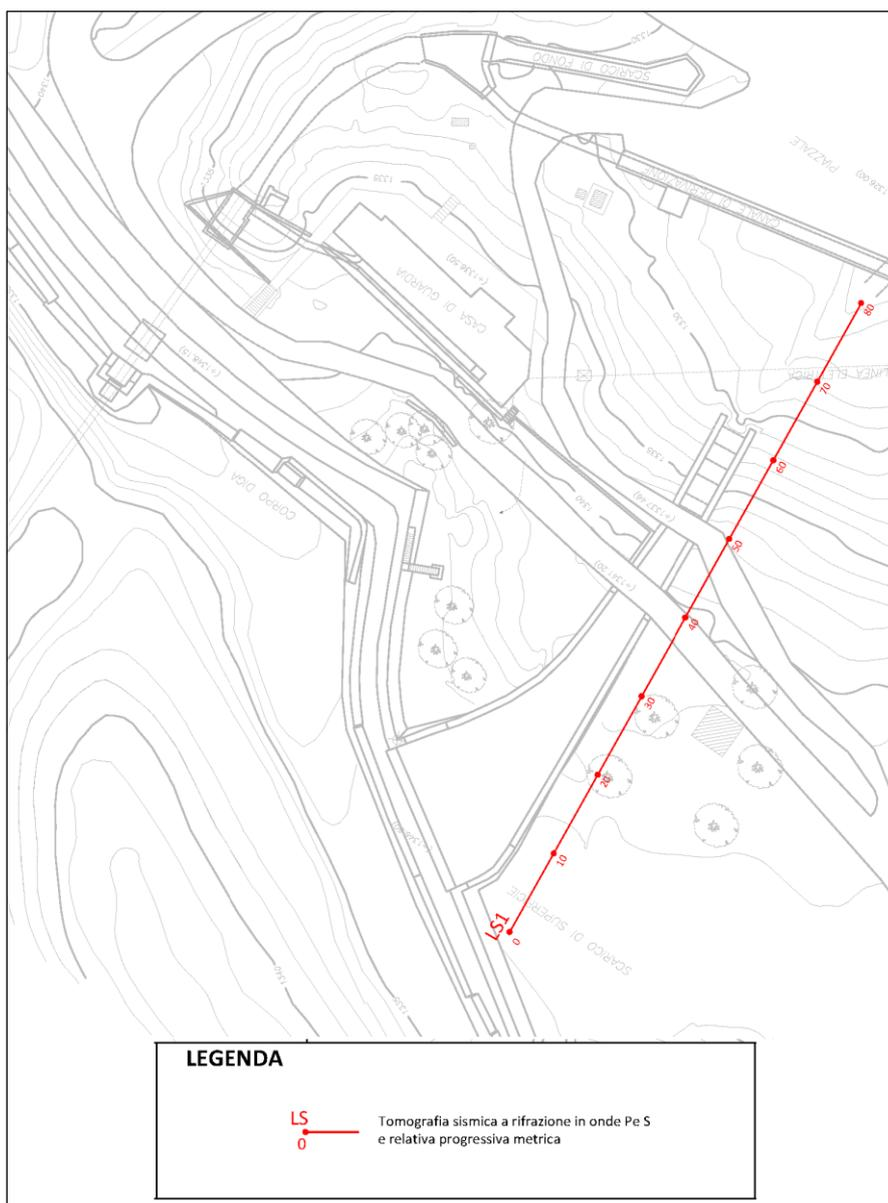
**Figura 4.25 Ubicazione dello stendimento di sismica a rifrazione con tomografia in onde P e S realizzato ad est dello sfioratore ed in direzione longitudinale allo stesso nel corso della (campagna indagini GeoExploration del 2020)**
