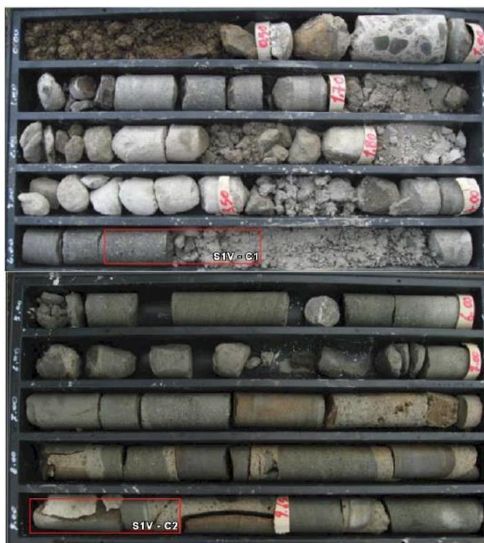
Figura 33 - campioni sottoposti al test di cessione
