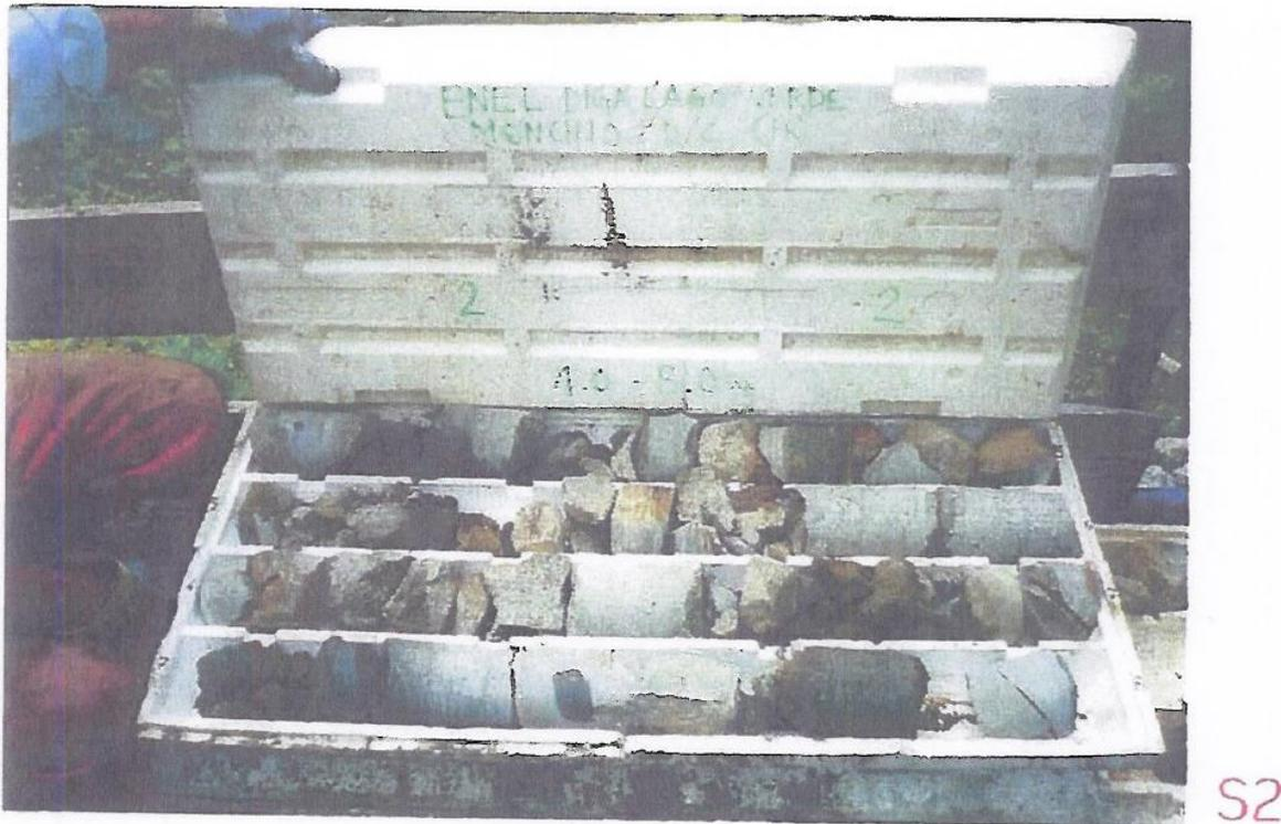
**Figura 4.1 Sondaggio S2 del 2000 (tra 4 e 8 di profondità) sulla muratura di pietrame e malta di calce. Si nota la totale assenza coesione tra i blocchi per mancanza della malta di calce (persa nel fluido di perforazione).**
