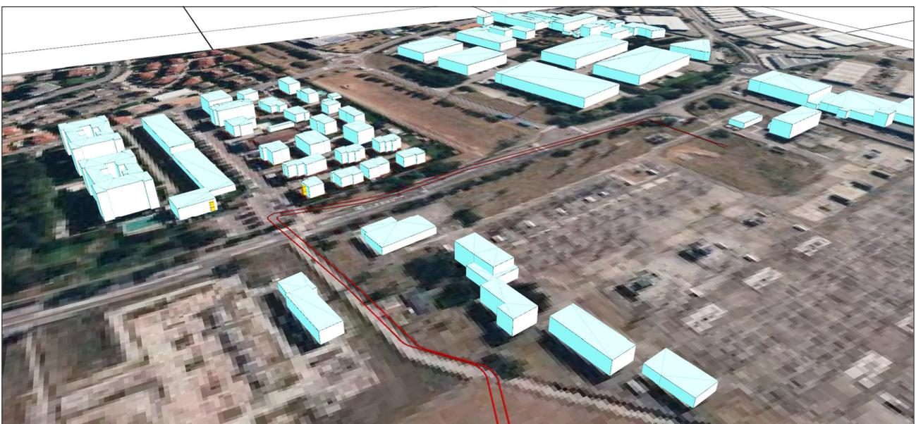
Figura 4/3 – Modello tridimensionale per il calcolo della propagazione delle onde sonore
