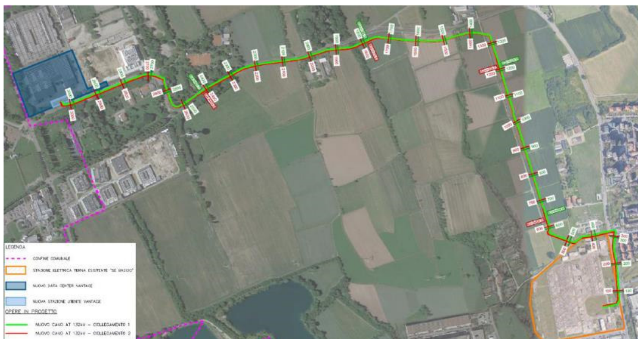
Figura 2.2 - Stralcio della planimetria degli elettrodotti a progetto
