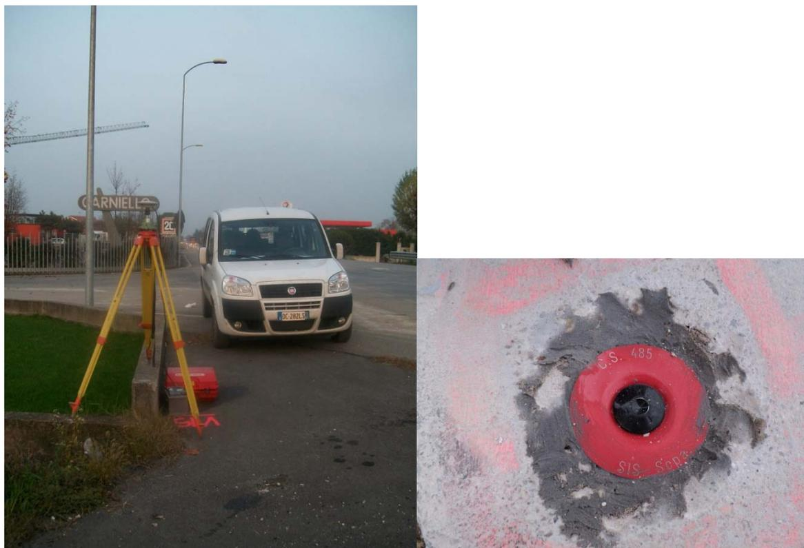
Figura 7.2– immagini dei manufatti utilizzati e tipologico caposaldo
