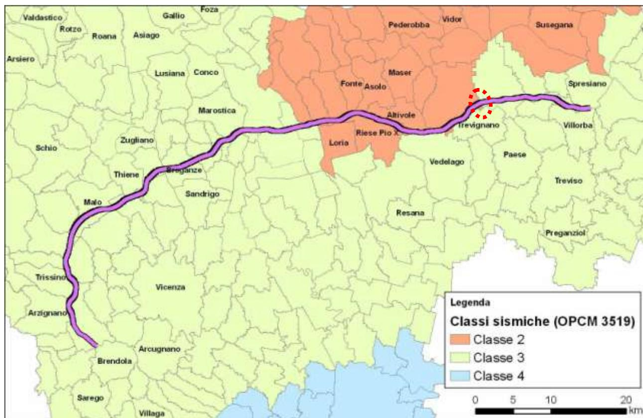
Figura 2.11: Mappa di classificazione sismica (OPCM 3519) - nel circolo in rosso la tratta in oggetto
