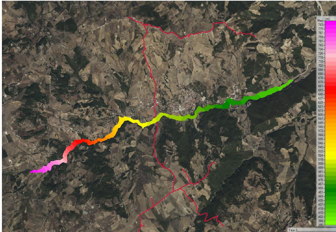
Figura 27 - Mappa della Water Surface Elevation
