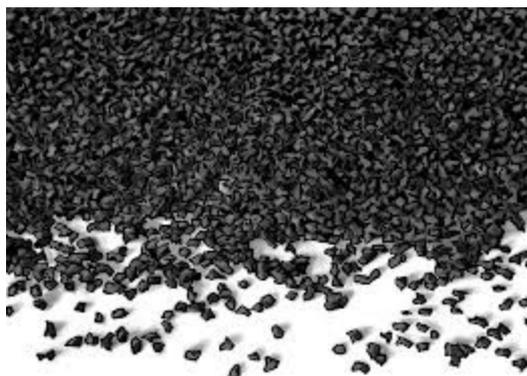
Figura 6-6 Campione di carbone attivo granulare
