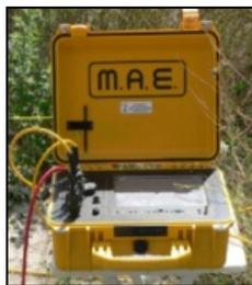
*Fig. 2: sismografo multicanale M.A.E. modello A 6000 S.*
