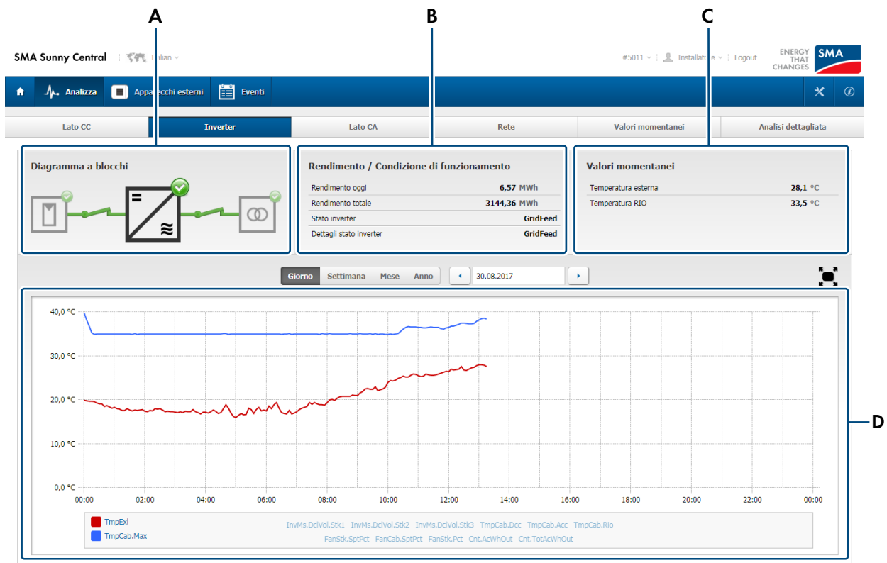
Figura 21: Pagina Inverter dell'interfaccia utente (esempio)
