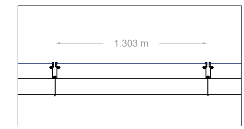
Particolare attacco pannello scala 1:20
