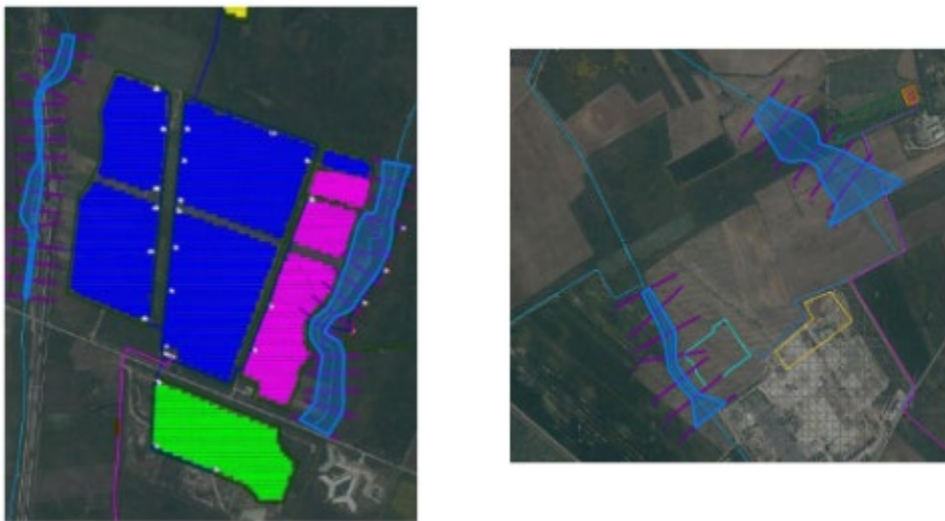
Figura 13 - Planimetria con indicazione delle aree inondabili duecentennali (sx area di impianto dei pannelli fotovoltaici, dx area relativa alle opere di connessione). Da RE02.1-StudioIdraulicoeIdrologico-R1_signed.pdf
