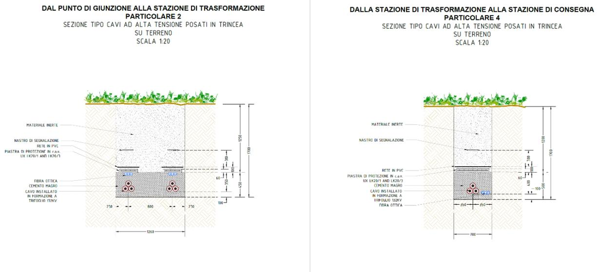
Figura 5-5: Sezione tipo cavi alta tensione (fuori scala, misure indicate in millimetri), posa interrata su terreno, nella casistica doppia/singola terna<sup>14</sup>.
