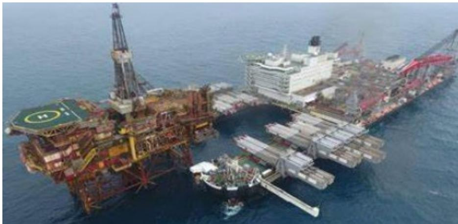
**Figura 4-2: Un'imbarcazione specializzata per il trasporto di carichi pesanti si prepara a sollevare la parte superiore di una piattaforma petrolifera.**
