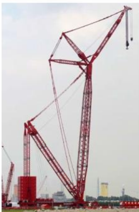
Figura 50: Esempio di gru ad anello.
