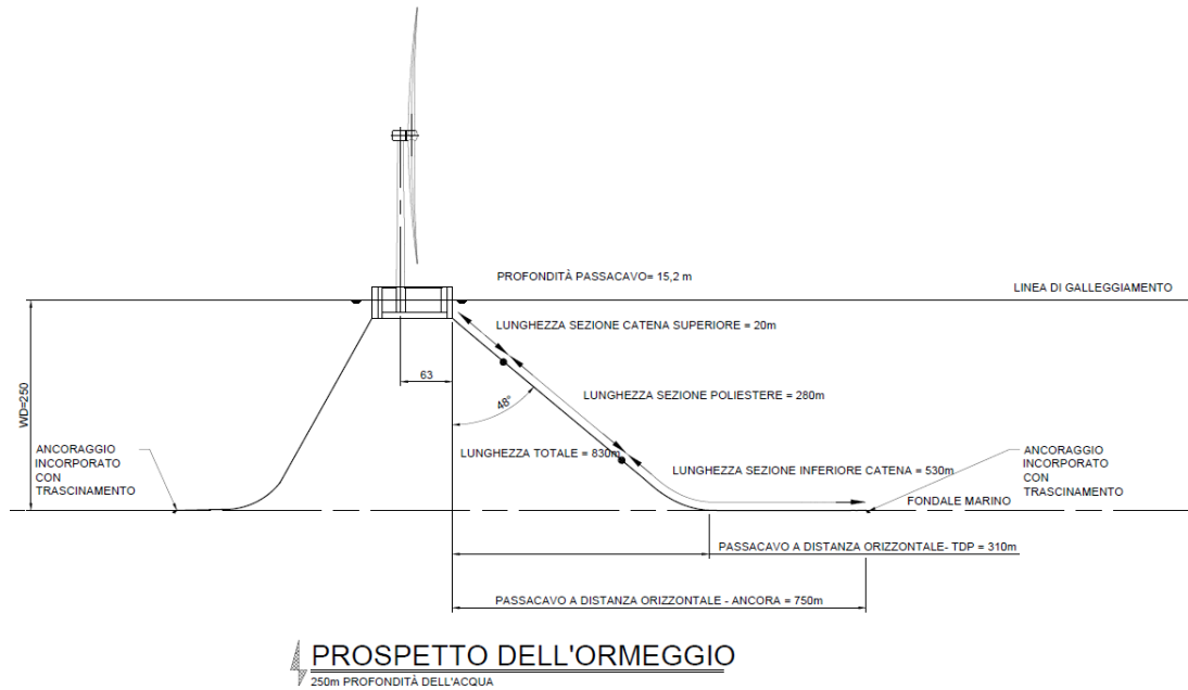
Figura 31: Principali parametri della linea di ormeggio valutati alla profondità massima (1350 m, in alto) e minima (250 m, in basso). Fonte: Tavole OW.ITA-SAR-GEN-OWC-ENV-DWG-57D e OW.ITA-SAR-GEN-OWC-ENV-DWG-57F.
