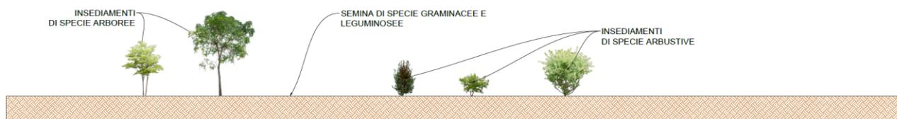
**Figura 22: Schema esemplificativo della gestione dei suoli e ripristino delle aree di cantiere**
