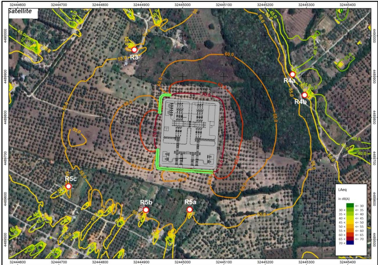
**Figura 3: Mappa di rumore fase di CANTIERE Stazione Elettrica 132/380 kV di Trasformazione.**
