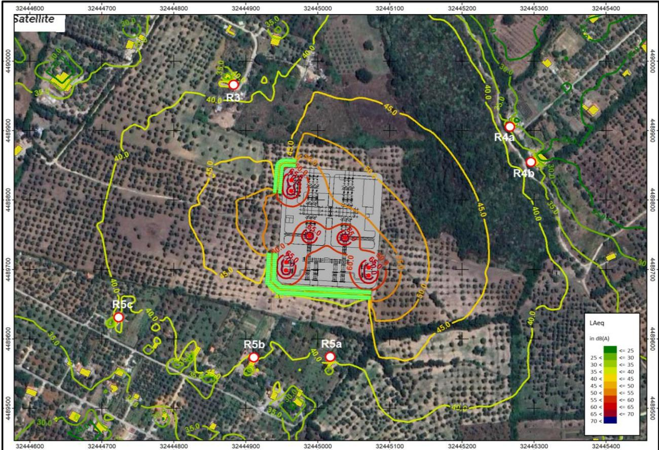
**Figura 5: Mappa di rumore fase di ESERCIZIO della Stazione 132/380 kV di Trasformazione.**
