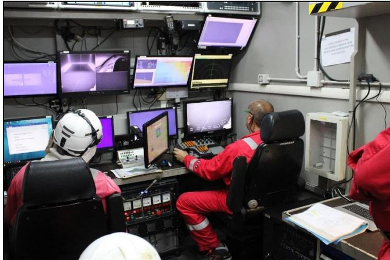
**Figura 67: La postazione di pilotaggio dei ROV durante le attività (foto ASPS)**
