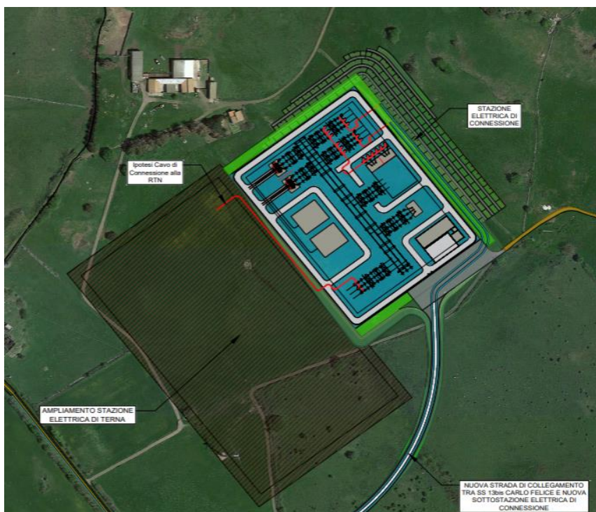
Figura 20: Stazione Elettrica di Connessione.
