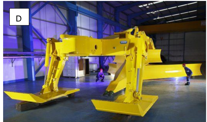
Figura 28: Mezzi per la posa dei cavi marini. A) Aratro B) Escavatore a getto C) Rock Trencher D) Aratro per la pre-posa del cavo.
