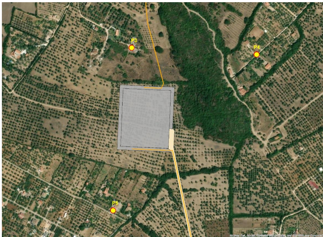
Figura 21: Punti di misura fonometrica ante operam P3÷P5 pressi Stazione Elettrica di Trasformazione 132/380 kV
