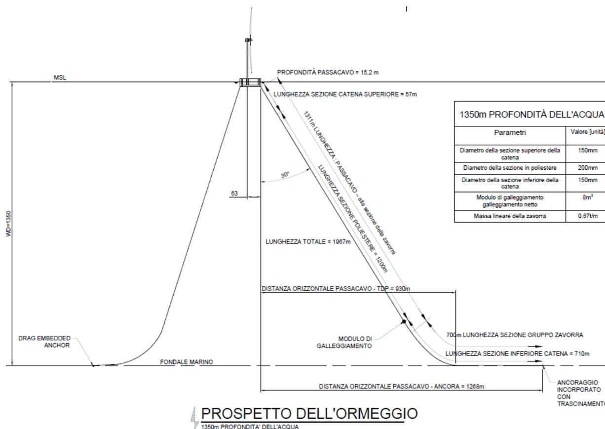
Figura 13: Principali parametri della linea di ormeggio valutati alla profondità massima (1350 m). Fonte: Tavole OW.ITA-SAR-GEN-OWC-ENV-DWG-53D e OW.ITA-SAR-GEN-OWC-ENV-DWG-53F.
