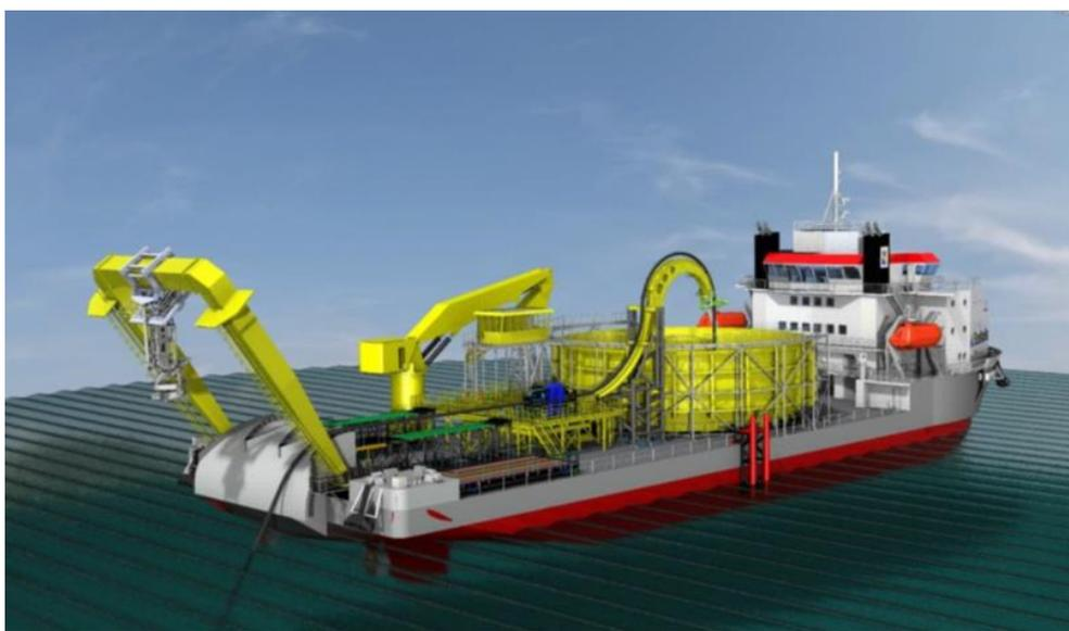
**Figura 32: Esempio di nave posacavi**
