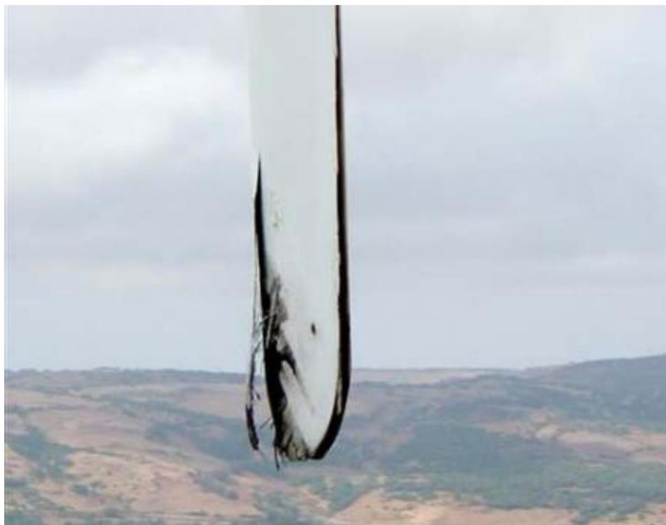
*Figura 4 - Estremità di pala danneggiata da fulminazione atmosferica*
