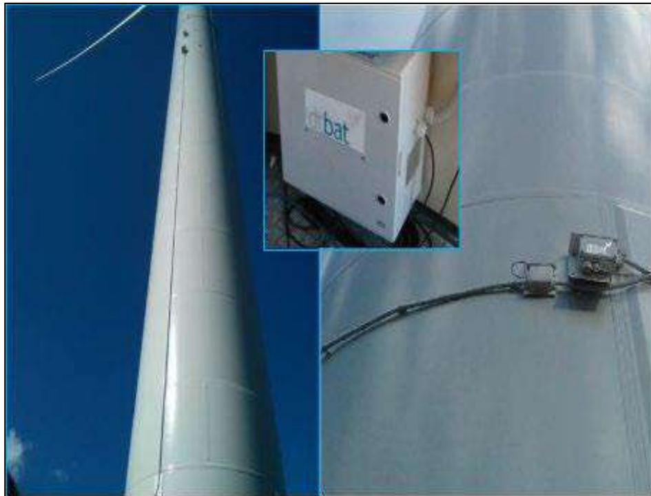
Figura 134: Esempio di sistema automatico installato su aerogeneratore al fine di limitare il rischio di collisione
