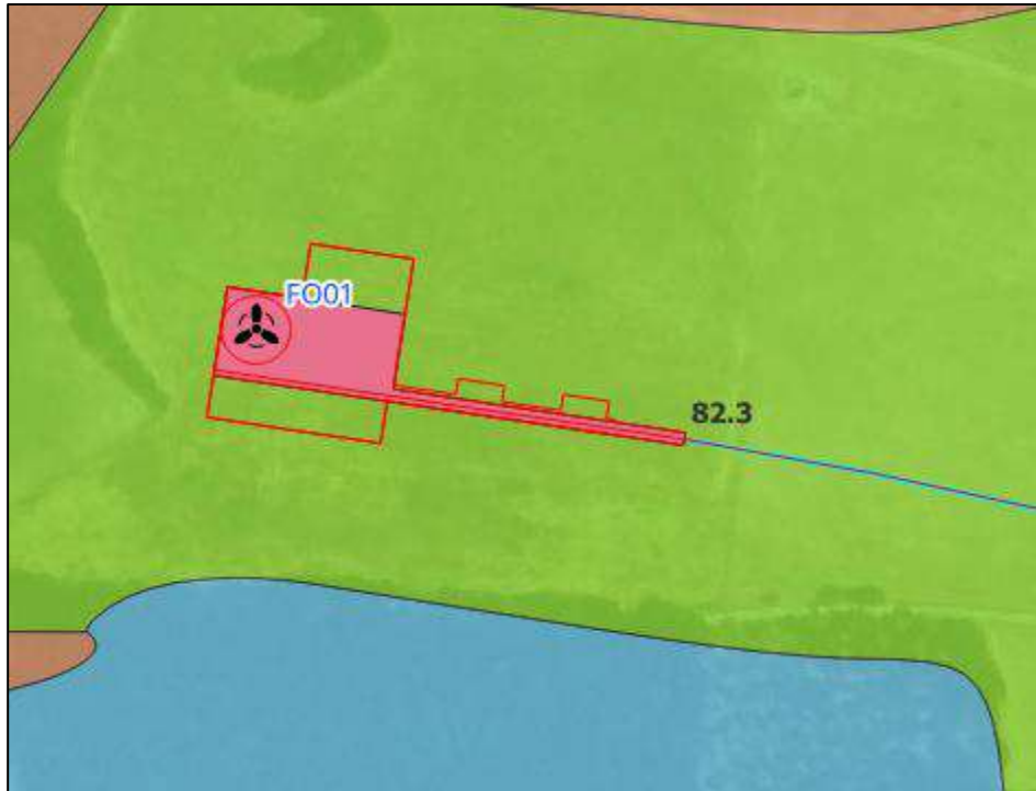
Figura 85: Aerogeneratore FO01 e relativa piazzola di montaggio (in rosso) e esercizio (in rosa), l'intera area è ubicata su quella che è definita dalla CNAT (Carta della natura ISPRA) un habitat 82.3 - Colture di tipo estensivo e sistemi agricoli complessi.
