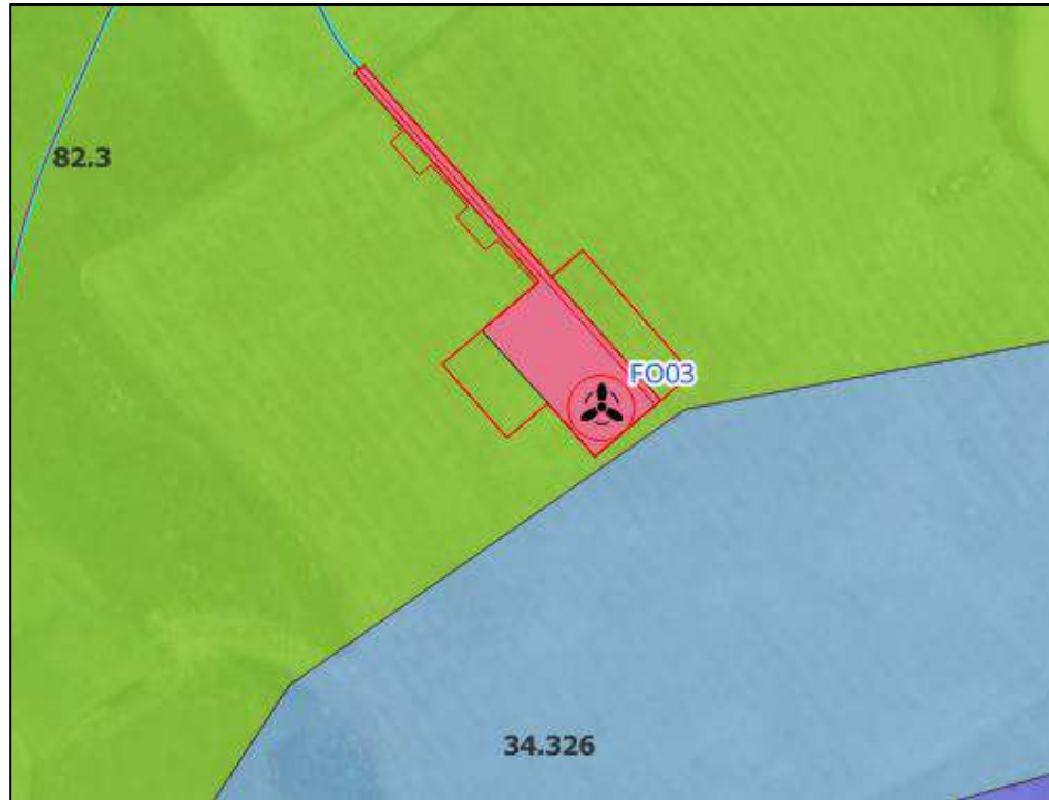
Figura 89: Aerogeneratore FO03 e relativa piazzola di montaggio (in rosso) e esercizio (in rosa), l'intera area è ubicata su quella che è definita dalla CNAT (Carta della natura ISPRA) un habitat 82.3 - Colture di tipo estensivo e sistemi agricoli complessi.
