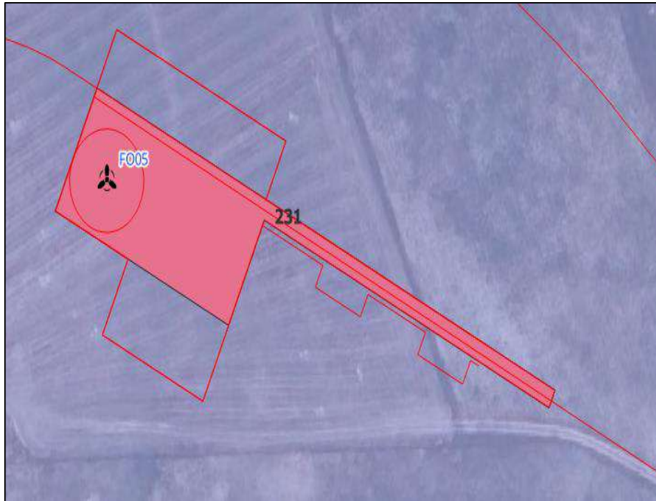
Figura 149: Aerogeneratore FO05 e relativa piazzola di montaggio (in rosso) e esercizio (in rosa), l'intera area è ubicata su quella che è definita dalla CLC (Corine Land cover 2018) un'area 231- Prati stabili
