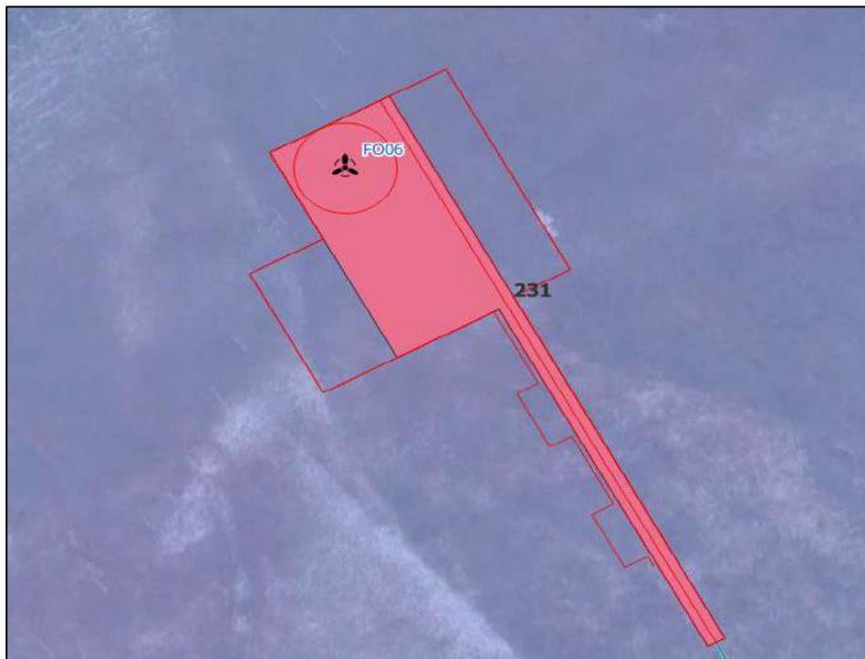
Figura 151: Aerogeneratore FO06 e relativa piazzola di montaggio (in rosso) e esercizio (in rosa), l'intera area è ubicata su quella che è definita dalla CLC (Corine Land cover 2018) un'area 231- Prati stabili
