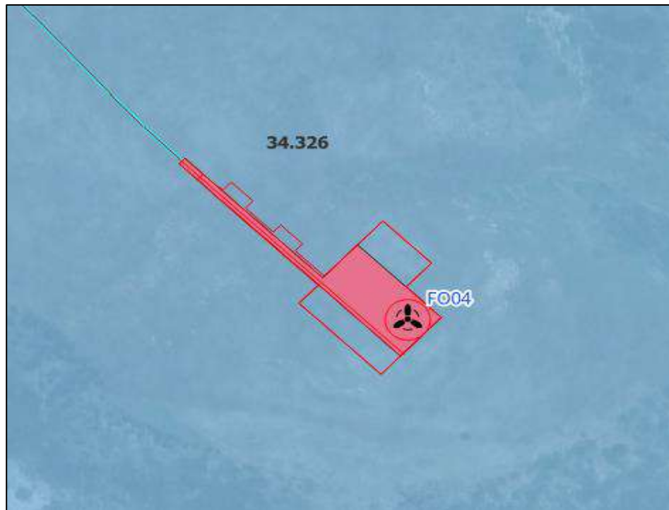
Figura 91: Aerogeneratore FO04 e relativa piazzola di montaggio (in rosso) e esercizio (in rosa), l'intera area è ubicata su quella che è definita dalla CNAT (Carta della natura ISPRA) un habitat 34.326 - Praterie xeriche del piano collinare (6210)
