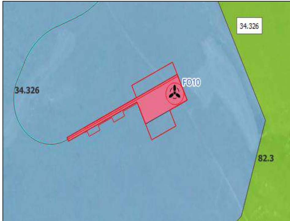
Figura 105: Aerogeneratore FO10 e relativa piazzola di montaggio (in rosso) e esercizio (in rosa), l'intera area è ubicata su quella che è definita dalla CNAT (Carta della natura ISPRA) un habitat 34.326 - Praterie xeriche del piano collinare (6210)
