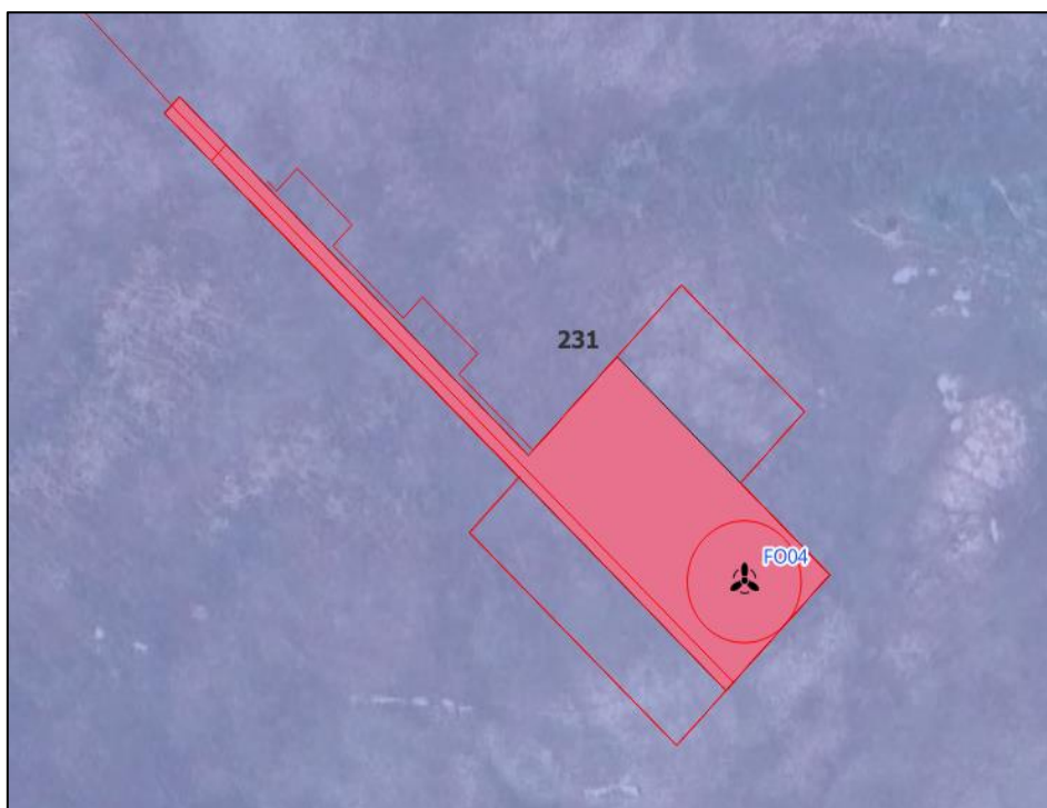
Figura 46: Aerogeneratore FO04 e relativa piazzola di montaggio (in rosso) e esercizio (in rosa), l'intera area è ubicata su quella che è definita dalla CLC (Corine Land cover 2018) un'area 231- Prati stabili
