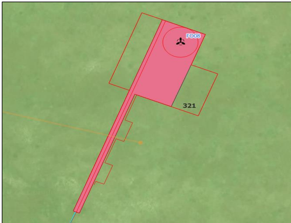
Figura 54: Aerogeneratore FO08 e relativa piazzola di montaggio (in rosso) e esercizio (in rosa), l'intera area è ubicata su quella che è definita dalla CLC (Corine Land cover 2018) un'area 321- Aree a pascolo naturale e praterie
