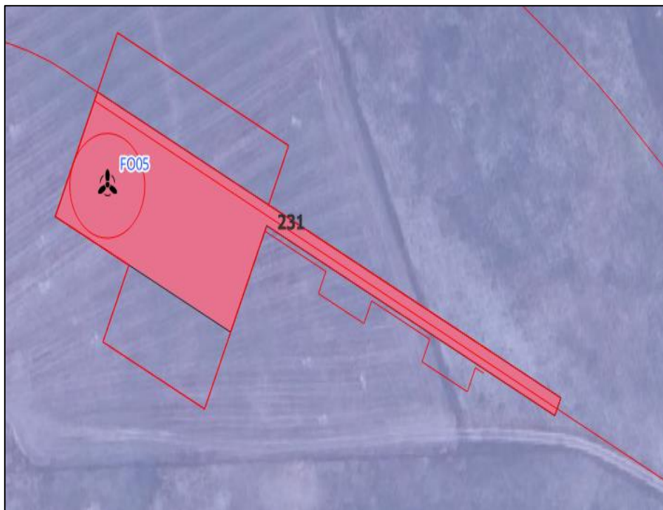
Figura 48: Aerogeneratore FO05 e relativa piazzola di montaggio (in rosso) e esercizio (in rosa), l'intera area è ubicata su quella che è definita dalla CLC (Corine Land cover 2018) un'area 231- Prati stabili
