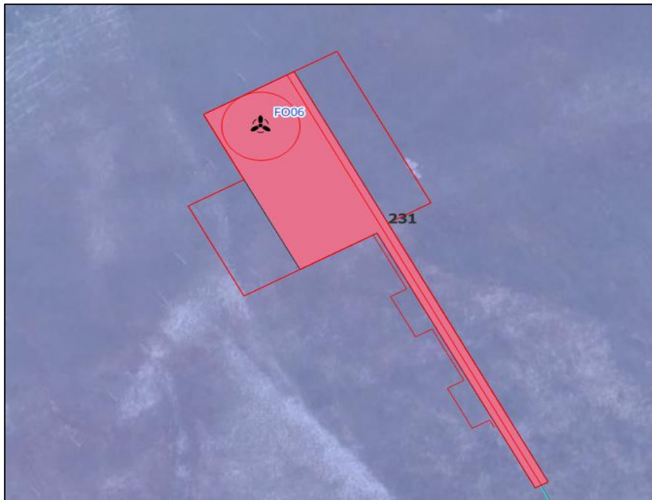
Figura 50: Aerogeneratore FO06 e relativa piazzola di montaggio (in rosso) e esercizio (in rosa), l'intera area è ubicata su quella che è definita dalla CLC (Corine Land cover 2018) un'area 231- Prati stabili
