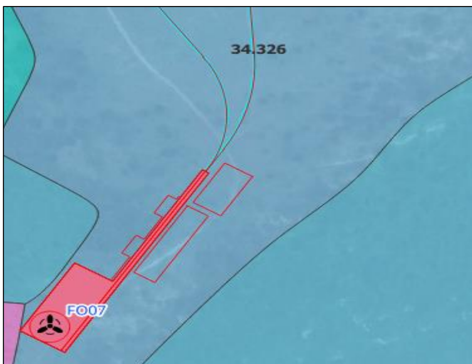
Figura 70: Aerogeneratore FO07 e relativa piazzola di montaggio (in rosso) e esercizio (in rosa), l'intera area è ubicata su quella che è definita dalla CNAT (Carta della natura ISPRA) un habitat 34.326 - Praterie xeriche del piano collinare (6210)
