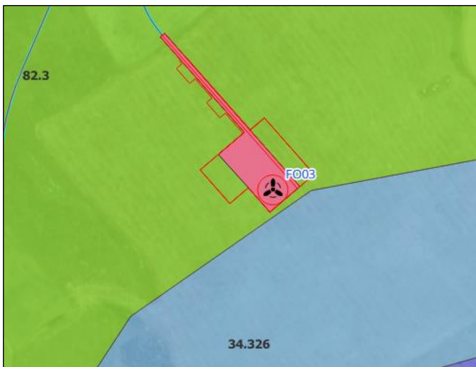
Figura 68: Aerogeneratore FO03 e relativa piazzola di montaggio (in rosso) e esercizio (in rosa), l'intera area è ubicata su quella che è definita dalla CNAT (Carta della natura ISPRA) un habitat 82.3 - Colture di tipo estensivo e sistemi agricoli complessi.
