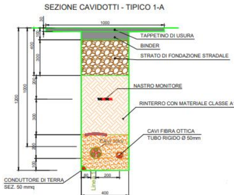
Figura 10: Sezione di scavo MT su strada asfaltata
