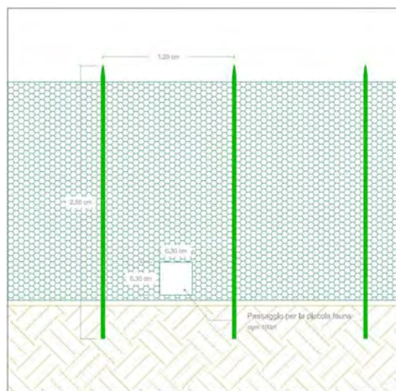
Figura 10-2 - Particolare recinzione passaggio piccola fauna
