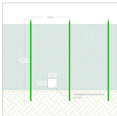
Figura 5-2 - Particolare recinzione passaggio piccola fauna
