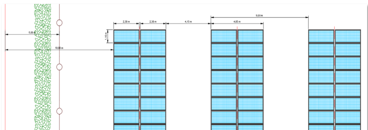
Figura 4-39 - Particolare costruttivo in pianta della recinzione e della barriera alberata, (per le opere agricole si rimanda alla relazione specialistica)
