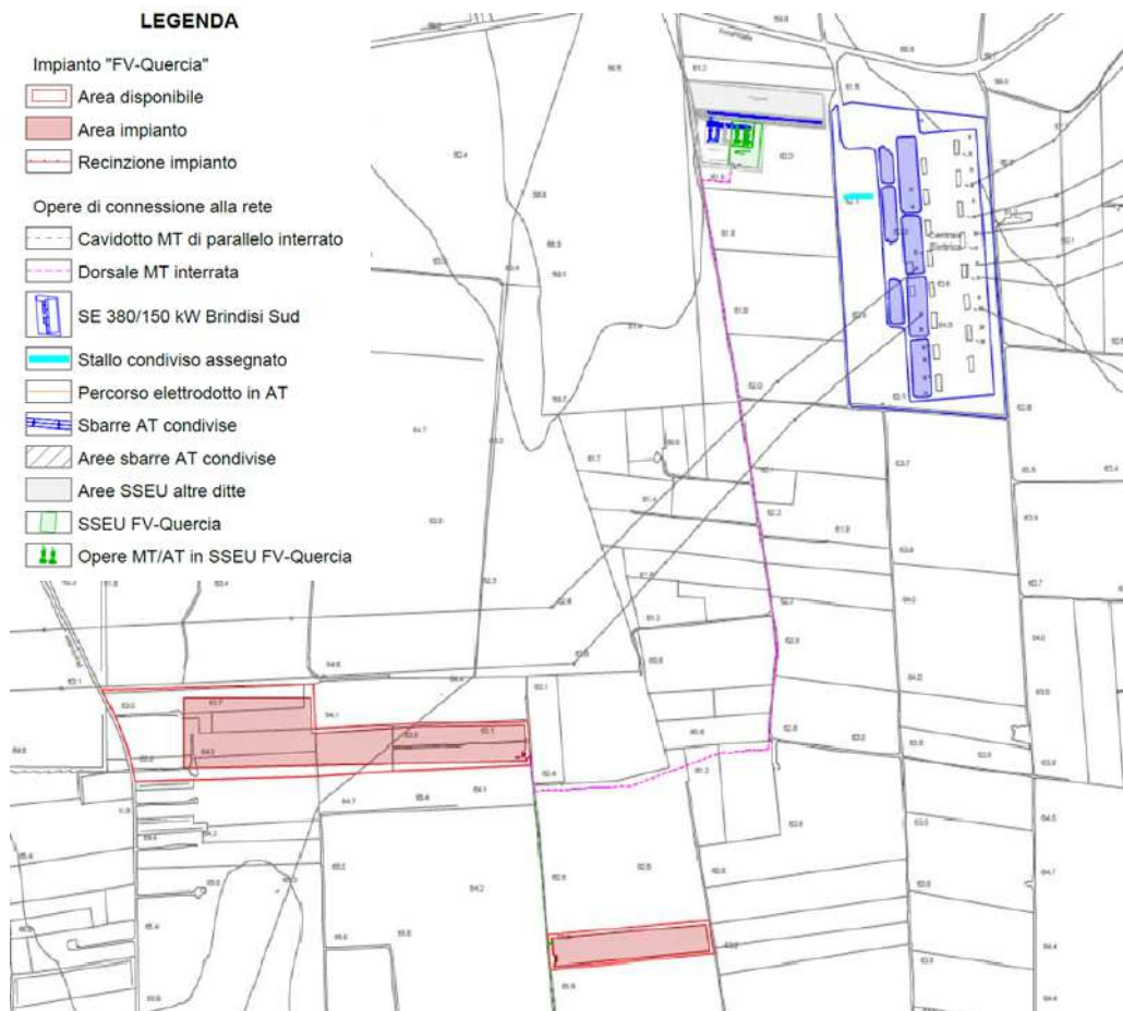
Figura 5-11 - Schema di convogliamento dell'energia dalla cabina di parallelo ubicata nel sotto-impianto FV-Parisi alla Stazione Elettrica di Trasformazione 380/150 kV "Brindisi Sud"
