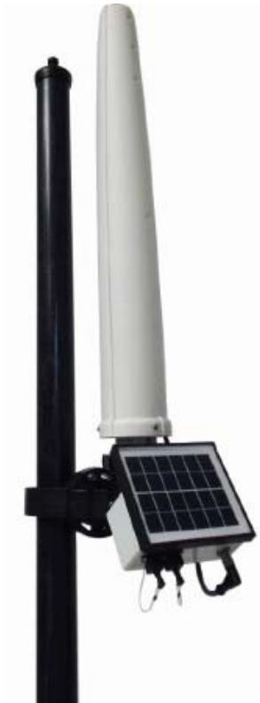
Figura 5-1 Dettaglio esempio della strumentazione di misura da installare su palo ancorato a terra
