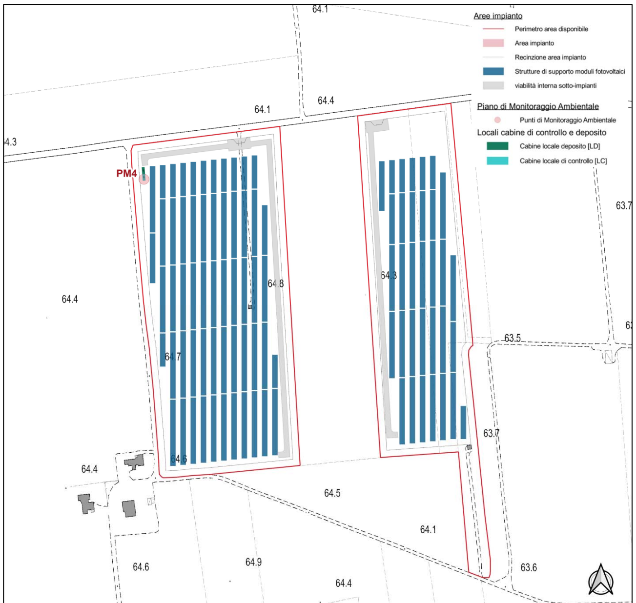
Figura 3-3 - Individuazione del punto di monitoraggio ambientale (PM4) ubicato nel sotto-impianto FV-Santa Teresa
